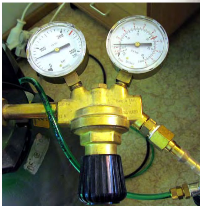
Kuva 3. Hiilidioksidin ulosvirtausta säätelee ensisijaisesti paineenalennusventtiili, joka on kiinni pullossa. Venttiilin vasemman puoleinen mittari näyttää pullossa olevan paineen ja oikean puoleinen venttiili kertoo hiilidioksidin tilavuusvirran (litraa minuutissa).
