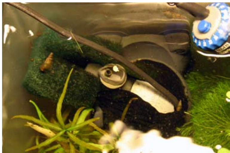
Pumpun suuaukon edessä on suodatinmaton palasta veistetty virtauksen ohjuri.
