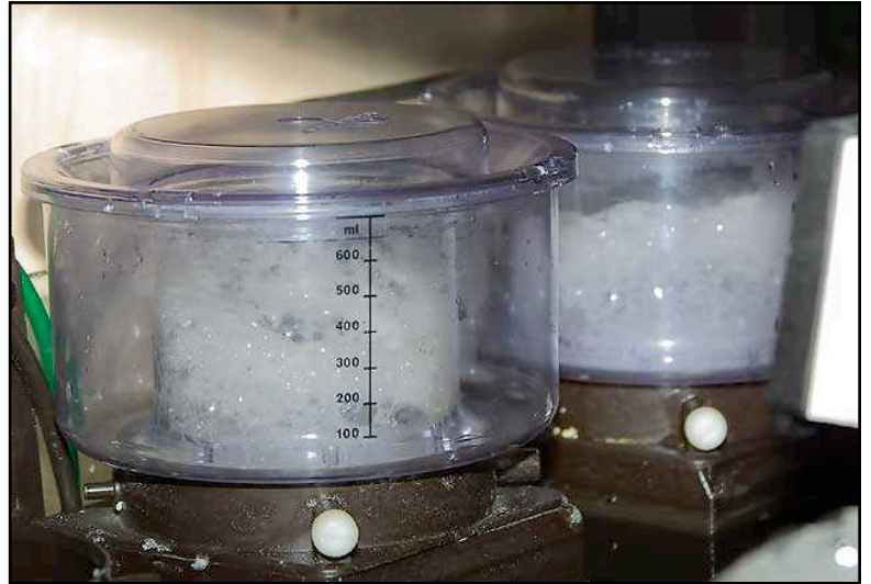
Kuva 3: Vaahdottimen tehtävänä on muodotaa vaahtoa sekoittamalla ilmaa ja vettä keskenään. Kuvassa kaksi Tunze 3130/2 mallista vaahdotinta.
